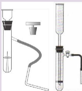
Рис. 7. Прибор для получения и собирания газов
