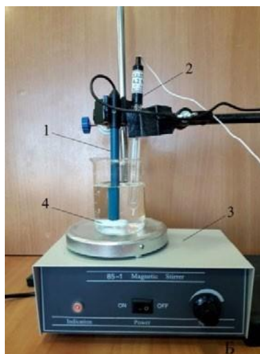
Рис. 2. Установка для определения концентрации (активности) хлорид-ионов в растворе. А: 1 — корпус датчика для определения Cl - -ионов; 2 — разъём MicroUSB для подключения к компьютеру; 3 — разъём BNC для подключения рабочего электрода; 4 — разъём для подключения электрода сравнения. Б: 1 — ионоселективный электрод (рабочий электрод); 2 — электрод сравнения (хлорсеребряный электрод); 3 — магнитная мешалка; 4 — якорь магнитной мешалки
